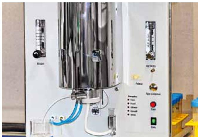
Рис. 3. Атомно-эмиссионный спектрометр «Павлин»
