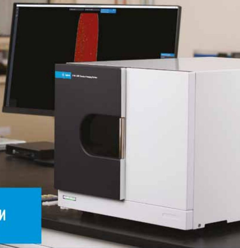
**Agilent 8700 LDIR – УНИКАЛЬНАЯ ЛАЗЕРНАЯ СИСТЕМА ВИЗУАЛИЗАЦИИ ХИМИЧЕСКОГО СОСТАВА**
